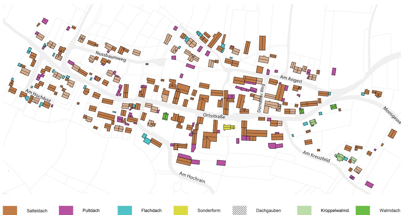
Abb. 45: Karte Dachlandschaft Das Satteldach überwiegt. Ge- bäude mit besonderer Funk- tion haben eine besondere Dachformen. Nebengebäude weisen Pult- oder Flachdächer auf.
