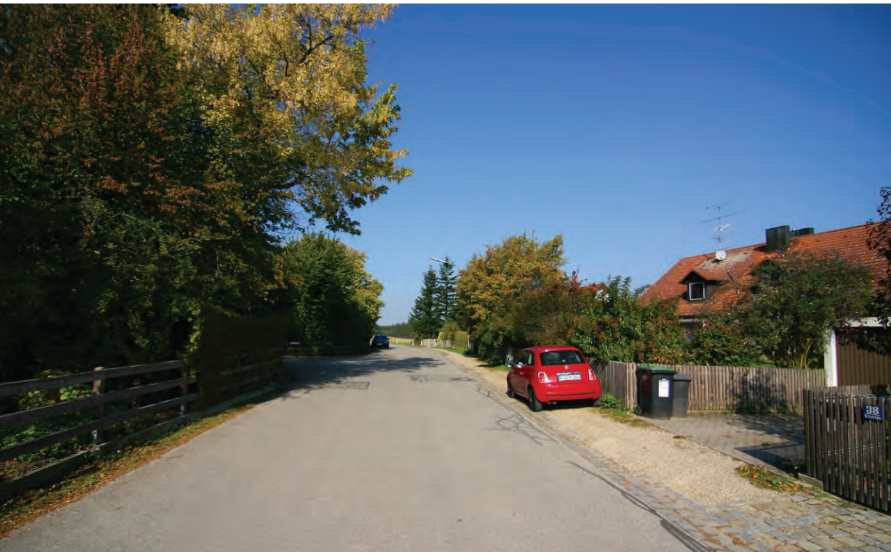
Abb. 147: Zum Parken braucht es im Dorf keinen markierten Parkplatz. Es reicht ein geschotterter Streifen entlang der Straße, der mal als Straßenraumerweiterung mal als Parkplatz oder Fußweg genutzt werden kann.
