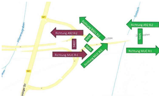
Abbildung 23: Lageplan Dauerzählstellen AS B 301 / Zentralallee
